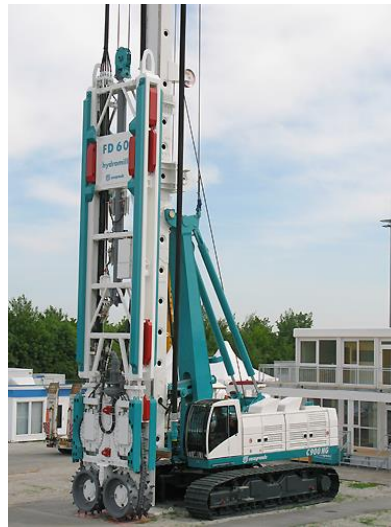
Hình A.1.3.4 Máy thi công tường trong đất với cụm công tác kiểu bánh phay có dẫn hướng.
